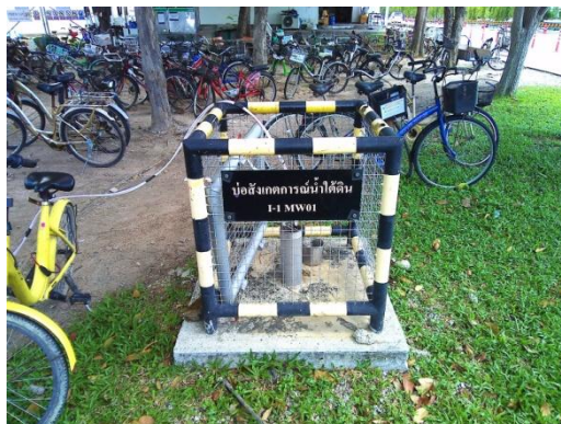
บ่อสังเกตการณ์น้ำใต้ดินตื้นน้ำ บริเวณด้านทิศใต้ของโรงงาน GC2 (MW01)
